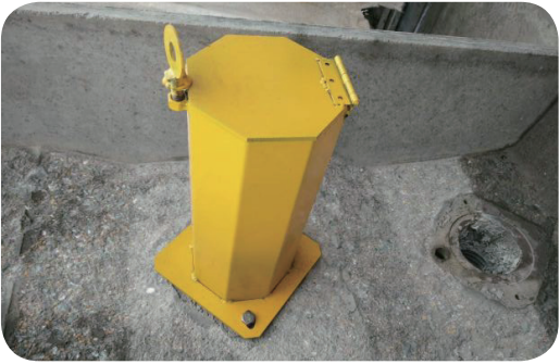
改进后： 设置限位防护罩，有效消除安全隐患
